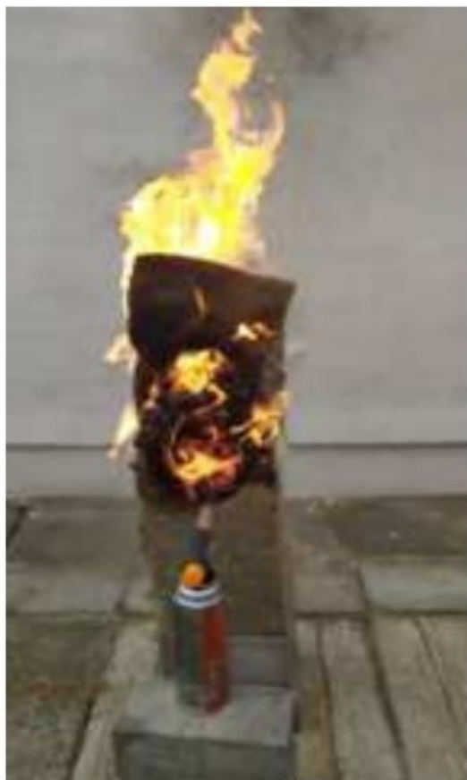
Рис. 12. Воздействие огня на плиту из льняных и полиэфирных волокон
