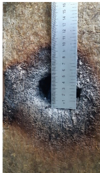
Рис. 11. Внешний вид плиты в момент устранения открытого пламени
