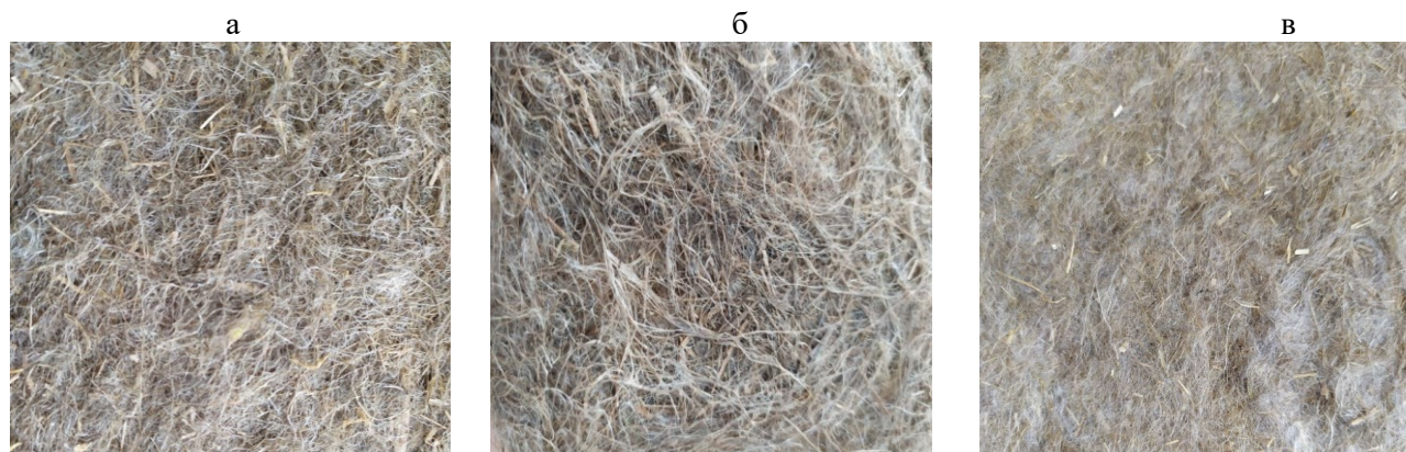
Рис. 1. Структура теплоизоляционных материалов а – из очесов льна, б – из волокон льна, в – из смеси льняных и полиэфирных волокон
